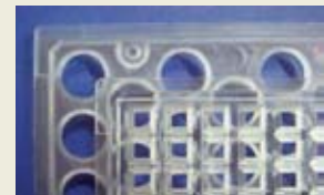
プラスチック端材を活用したレンズ蒸着用トレイ
